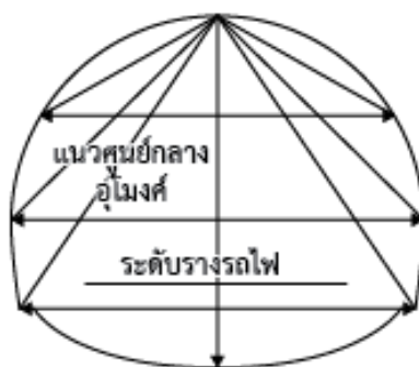
รูปที่ 5 ตัวอย่างการวางแผนการตรวจวัดสำหรับวิธีขุดแบบชั้นบันไดสามชั้น (ที่มา “Q/CR 9604-2015”)
