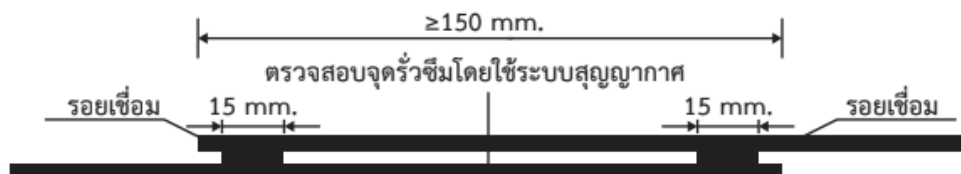
รูปที่ 9 การเชื่อมรอยต่อเมมเบรนกันน้ำ (ที่มา “Q/CR 9604-2015”)
