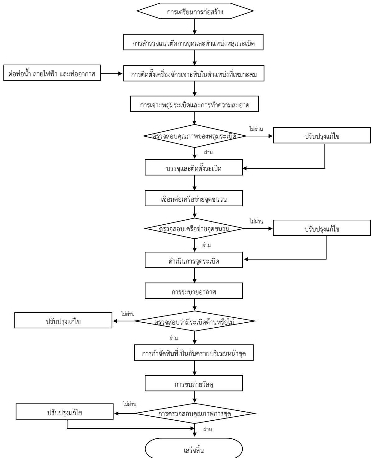
รูปที่ ก.6 แผนผังการเจาะและการระเบิด (ที่มา “Q/CR 9604-2015”)
